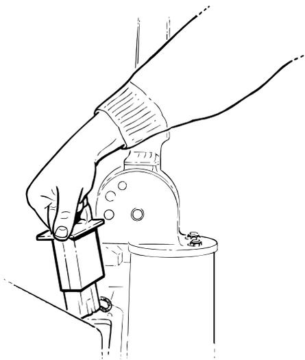
Batterie-Trennvorrichtung herausziehen (siehe Abbildung), um die Stromversorgung zu unterbrechen, z.B. bei:
